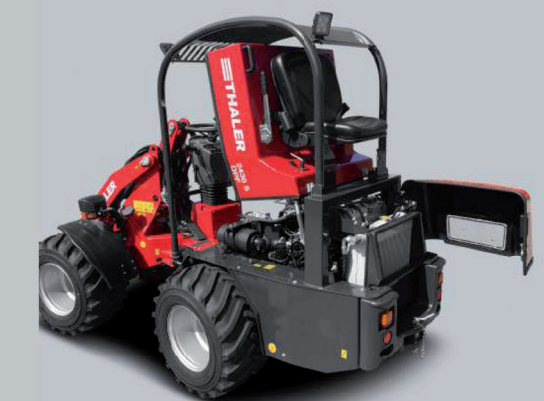
Łatwa konserwacja - dostęp do wszystkich głównych punktów serwisowych można uzyskać w bardzo łatwy sposób.
